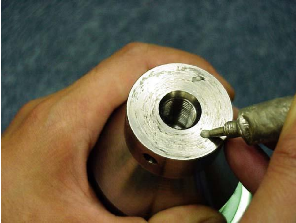
增幅器接续面
